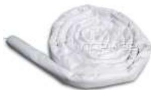
1. **Минибоны сорбирующие** - отличаются небольшим диаметром и простотой конструкции. Минибон представляет собой сорбирующий рукав с полимерным наполнителем, заключенный в сетку, на концах которого есть завязки для соединения бонов друг с другом. Сетка является одновременно оболочкой сорбирующего изделия и несущим элементом.
